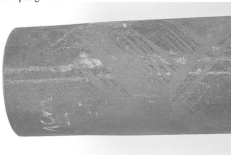
1. sz. fénykép Folyási vonalak a magon terhelt oszlop végén
